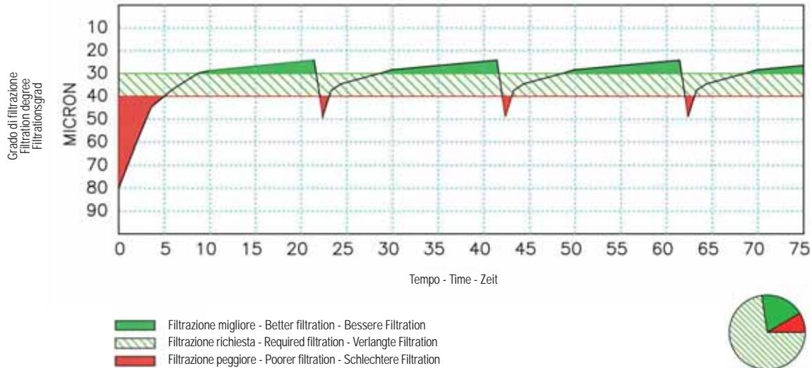
Ciclo di funzionamento e andamento della filtrazione in un sistema sottodimensionato
